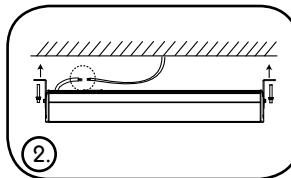
2. Conectar la línea de alimentación a la caja de funciones. Asegurarse de la conexión correcta de la línea fase, la neutro y la de tierra. Proceder con precaución para mantener el grado IP.
