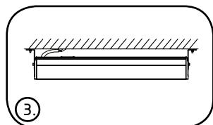
3. Atornillar los enganches después de fijar la línea de alimentación.
