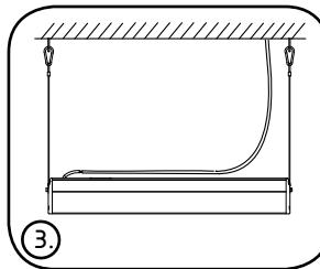
3. Fijar los enganches al techo después de conectar la línea de alimentación.
