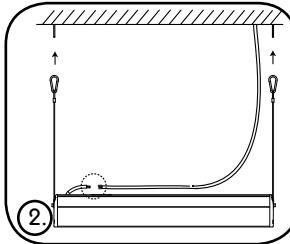
2. Conectar la línea de alimentación a la caja de funciones. Asegurarse de la conexión correcta de la línea fase, la neutro y la de tierra. Proceder con precaución para mantener el grado IP.
