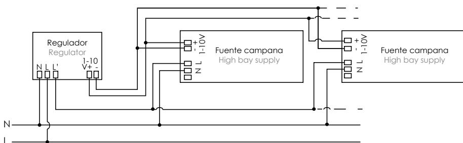
**NOTA:** Si no se desea emplear la opción regulable, no conectar los cables de regulación. **NOTE:** If it is not desired to use the dimming option, do not connect the dimming cables.
