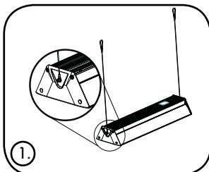
1. Fijar los cables de montaje a los extremos de la luminaria.
