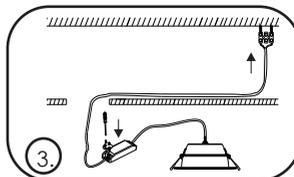
3. Conectar los cables de alimentación. En caso de opción regulable, conectar los cables de regulación a la fuente.
