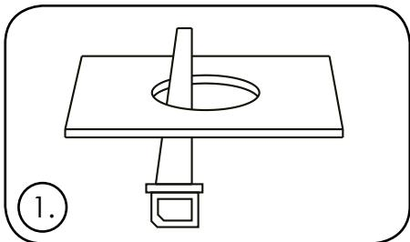
1. Realizar un agujero de 65mm de diámetro. 1. Drill a hole in a diameter of 65mm.
